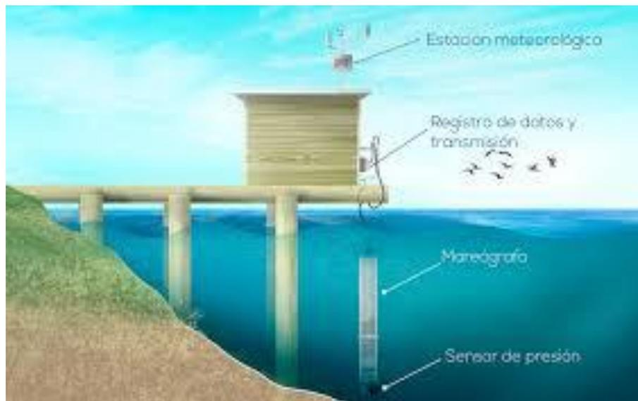
**Figura 13.** Mareógrafo de presión. Recuperada de <https://slideplayer.es/slide/14115031/>
