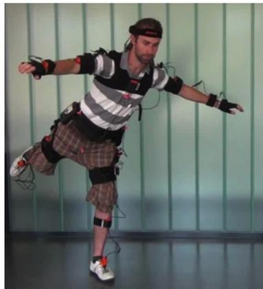
(a) Sensores inerciales usado en [10]
