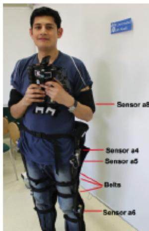
Figura 2.2: Sistema de Captura de Movimientos propuesto por [71].
