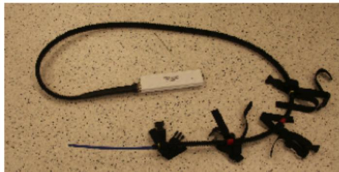
Figura 2.7: Banda de fibra Óptica de la compañía Measurand's Inc. utilizado por Aleotti [27] para capturar movimientos de un brazo.
