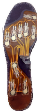
Figura 3.5: Sistema de clasificación plantar con 10 sensores. Adaptado de Mei et al. (2020).
