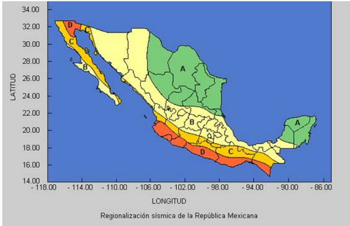
**Figura 12.** Cuatro zonas sísmicas en México definidas por el Servicio Geológico Mexicano. Figura tomada de (<https://www.sgm.gob.mx/Web/MuseoVirtual/Riesgos-geologicos/Sismologia-de-Mexico.html>).
