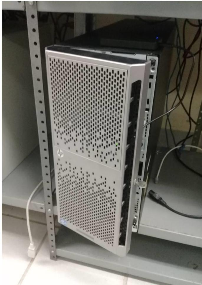
**Figura 14.** Servidor HP ProLiant ML350p Gen8. El disco duro externo de 2 TB se encuentra conectado a uno de los puertos USB del Servidor.
