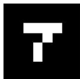
Figura 4.5. Ejemplo de marca fiducial, de la cual se obtiene su matriz de transformación con respecto a la cámara.
