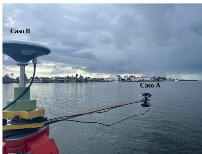
Figura 20. Arquitectura para la toma de datos GNSS con receptores y antenas de bajo costo.
