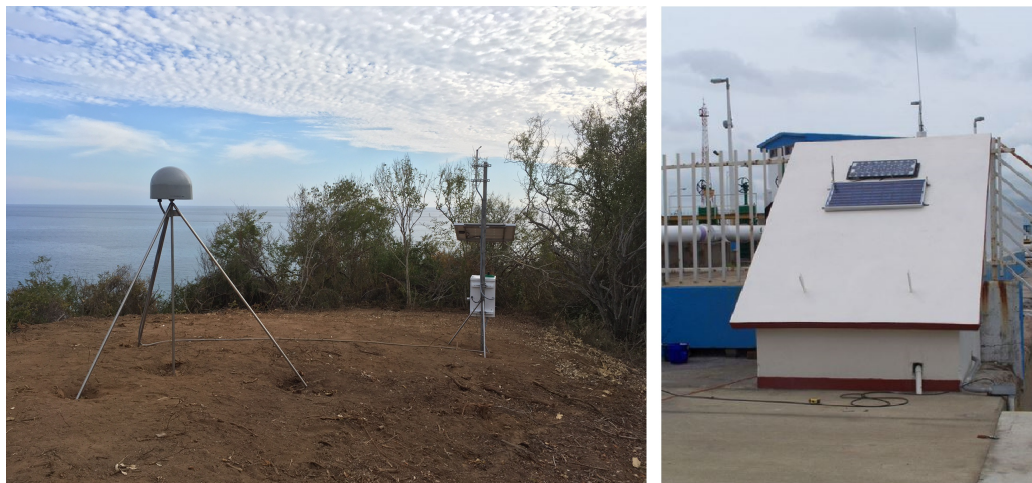
Figura 3.5: Sitio de instalación del GNSS TNTM (izquierda) y del mareógrafo Manzanillo instalado por el Servicio Mareográfico Nacional (derecha).
