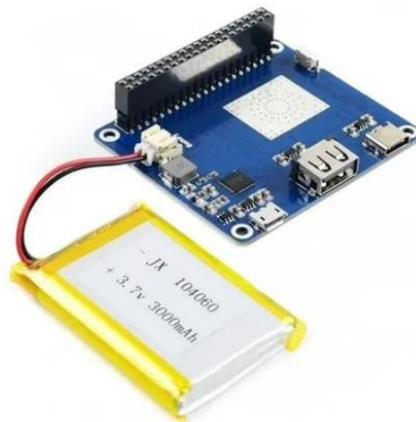
*Figura 38: Módulo de batería Raspberry Pi 4 Hat.*
