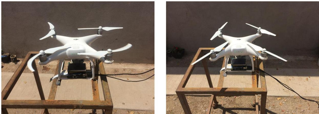
*Figura 45: Operación del sensor con sistema de propulsión activado (izquierda) y con sistema de propulsión desactivado (derecha).*
