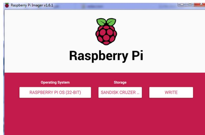
*Figura 40: Instalación de SO Raspberry Pi.*
