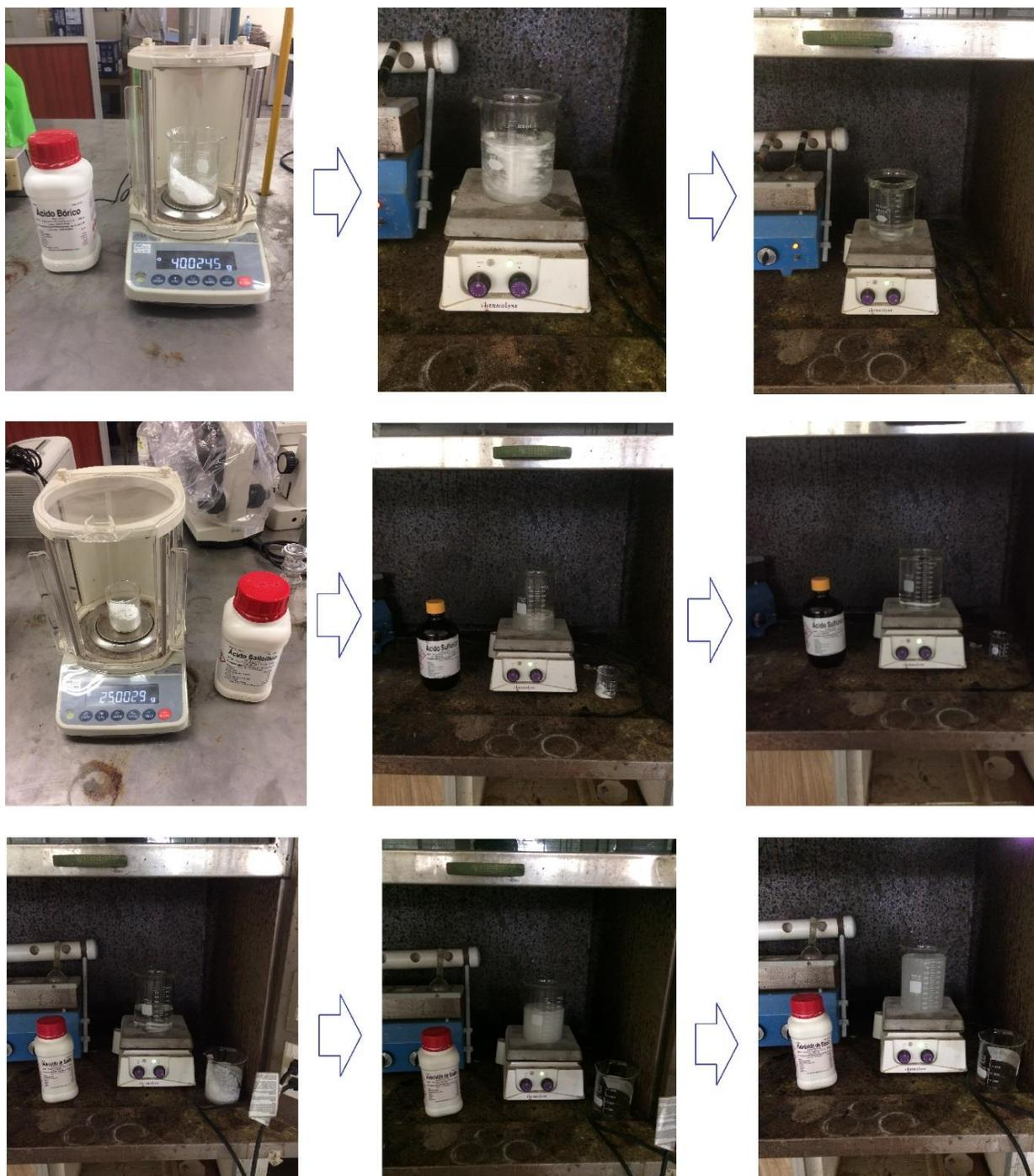
Figura 26: Preparación de la solución de ácido sulfúrico (arriba), ácido bórico (al centro) e hidróxido de sodio (abajo).
