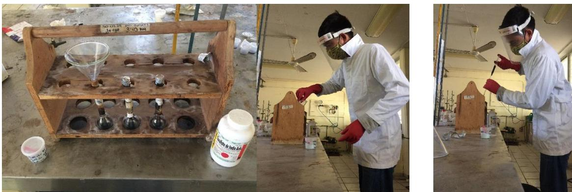
*Figura 30: Agregación de tiosulfato de sodio, catalizador (izquierda) y agua destilada (derecha).*
