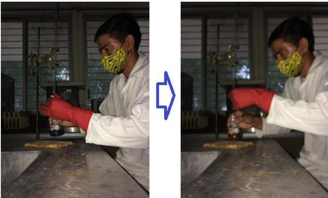
Figura 33: Titulación, a la izquierda, se toma la lectura inicial en la bureta del nivel de ácido sulfúrico, a la derecha, la lectura final.
