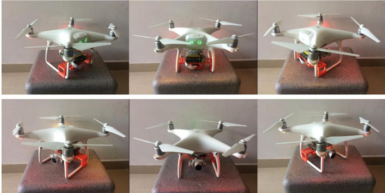
*Figura 69: Montaje del sensor NIR en el VANT.*
