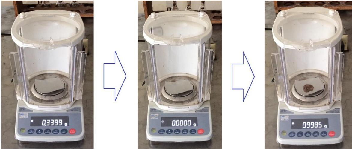
Figura 28: Peso de la muestra de suelo para análisis Kjeldahl.
