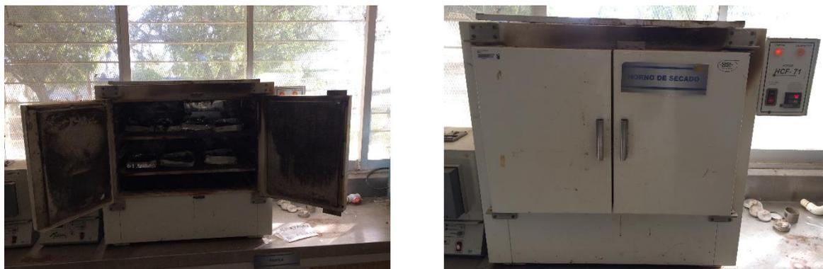
*Figura 25: Secado de muestras de suelo en horno eléctrico a 60°C durante 24 horas.*
