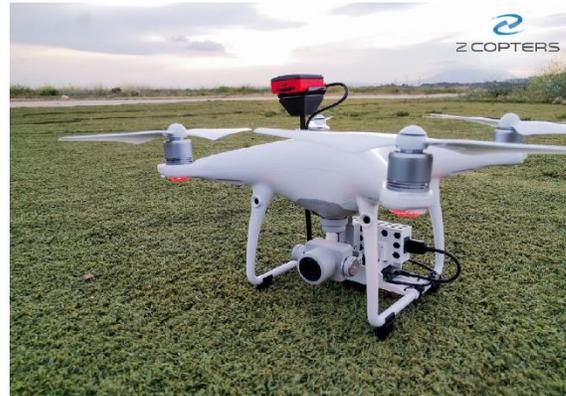
Figura 46: Phantom 4 Pro equipado con el sensor RedEdge de Micasense (izquierda) y con el sensor Parrot Sequoia (derecha). Fuente: (COPTERLab, 2021) (Z COPTERS, 2021).
