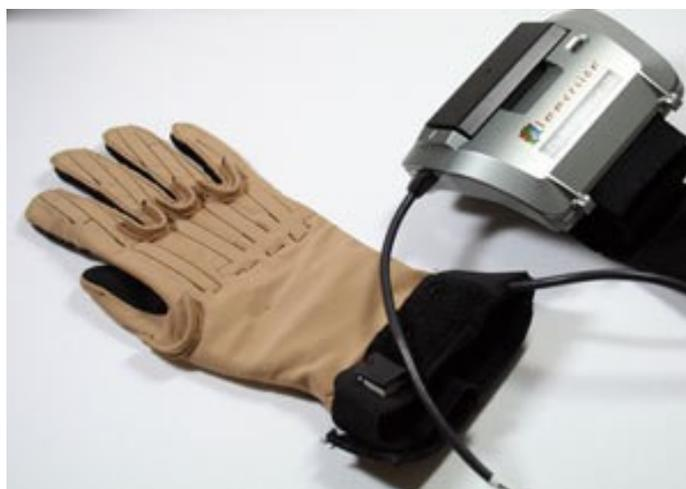
FIGURA 2.15. Guante de datos CyberGlove.
