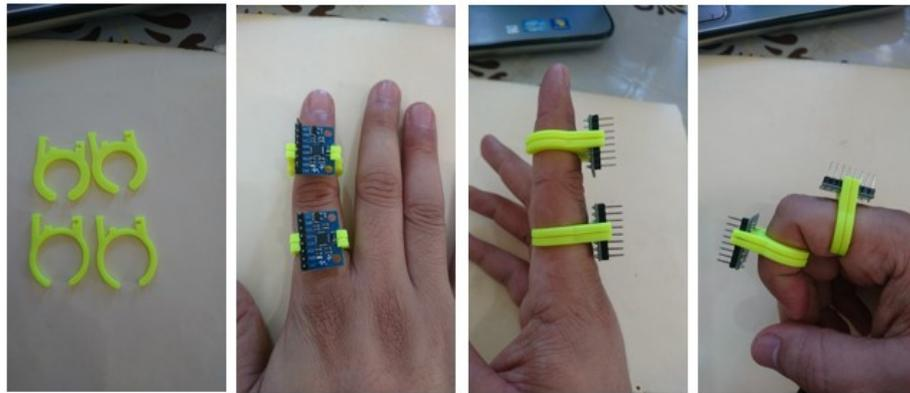
FIGURA 3.18. a) Nuevo diseño. b) c) d) Colocación de los anillos con los sensores en las falanges.
