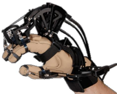
FIGURA 2.16. CyberGrasp montando en la mano del usuario.
