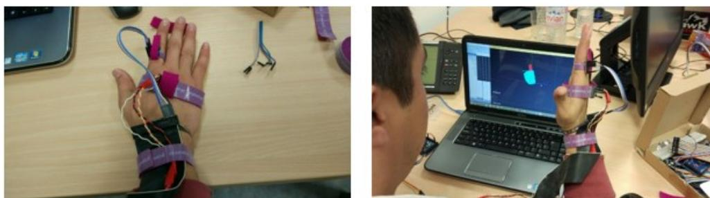
FIGURA 3.16. a) Colocación de los sensores. b) Validando movimientos de palma y falange proximal.
