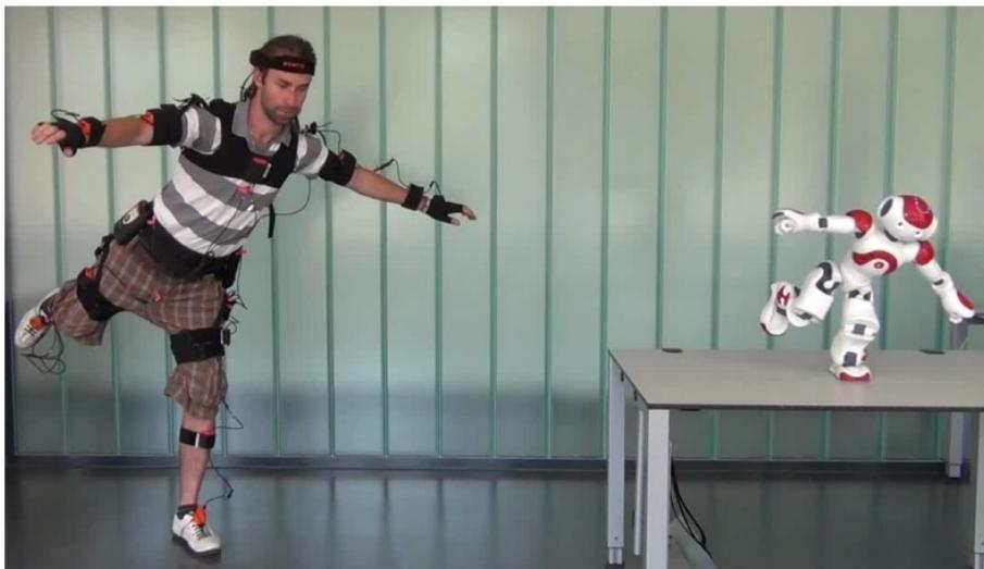
FIGURA 2.12. Sistema de captura de movimientos basado en sensores inerciales.
