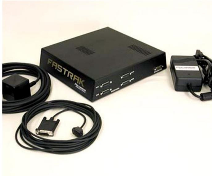
FIGURA 2.10. Sistema de captura de movimientos electromagnéticos.
