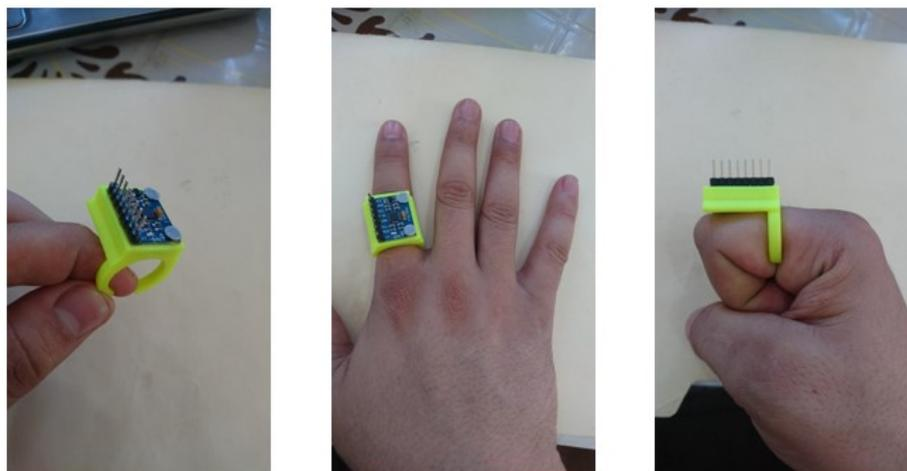
FIGURA 3.17. a) Colocación del sensor en el prototipo. b) Puesto en la mano del usuario. c) Durante la flexión de la falange proximal.
