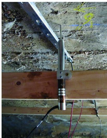
**Figura 5.2:** Sensor LVDT instalado sobre el puente *El Carrizo*.
