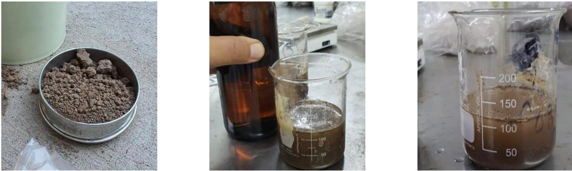
*Nota.* Tamizado la muestra (Izquierda); Solución Calgón en muestra de suelo (Centro y derecha).
