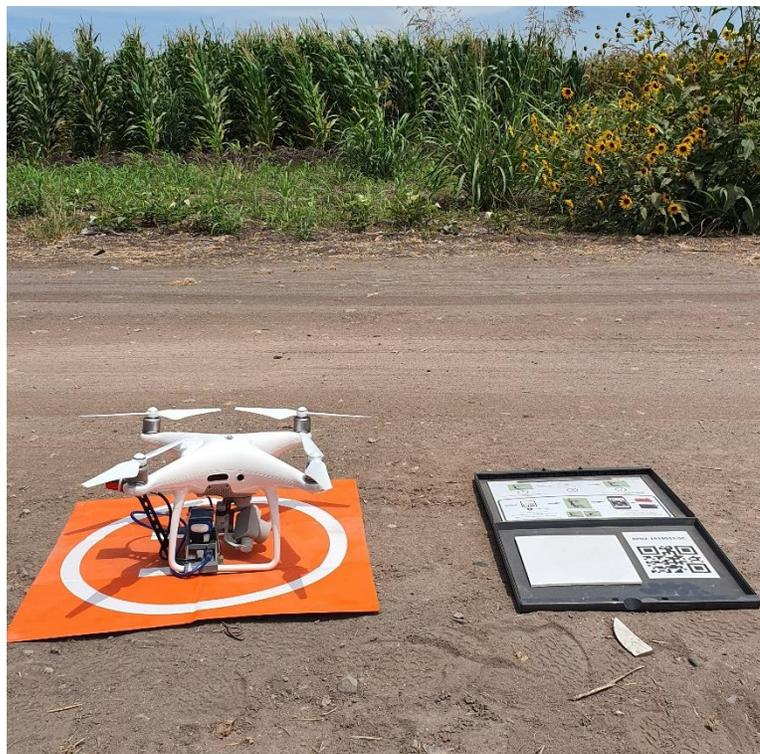
*Nota.* Se observa el pad abierto para la calibración frente al Sol (Derecha) y el RPAS con el sensor montado para realizar los vuelos fotogramétricos.
