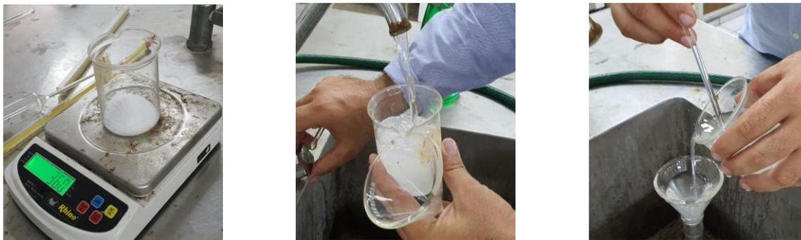
*Nota.* Se pesan los gramos requeridos de Hexametafosfato de Sodio para realizar la solución (Izquierda); se vierte agua para diluir por completo hasta no dejar grumos (Centro) y se deposita en un matraz aforado a 1 litro (Derecha).
