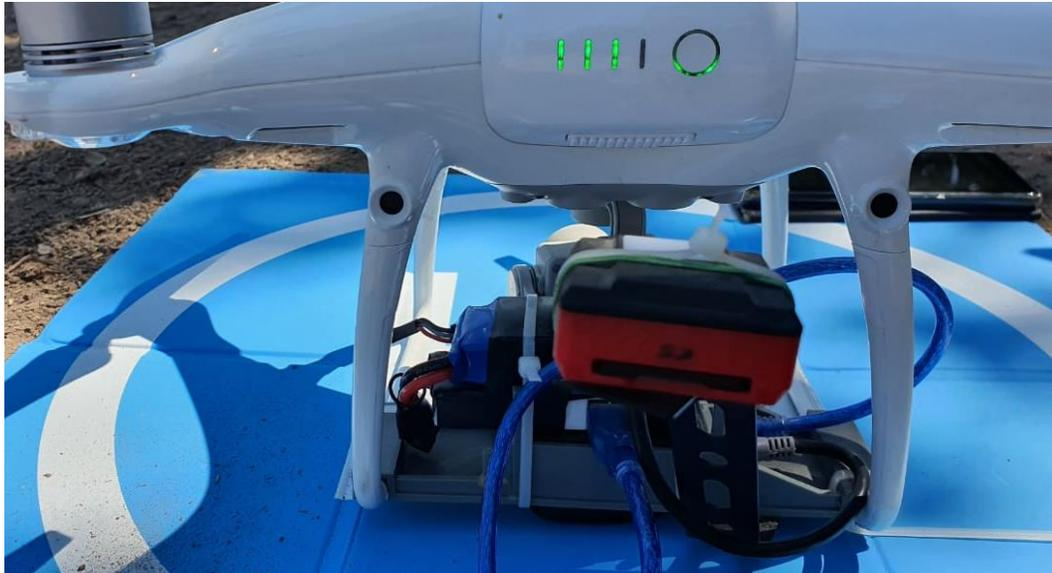
Una vez configurado con la interfaz del dispositivo externo y la conexión wifi, se configuraron los parámetros de las capturas de imágenes, de modo a distancias regulares, indicadas en metros entre cada fotografía. Las tomas de cada una de ellas fueron tomadas con la configuración que tendrá el vuelo del RPAS, siendo éstas independientes la planeación y manejo del vuelo a la del sensor multispectral.
