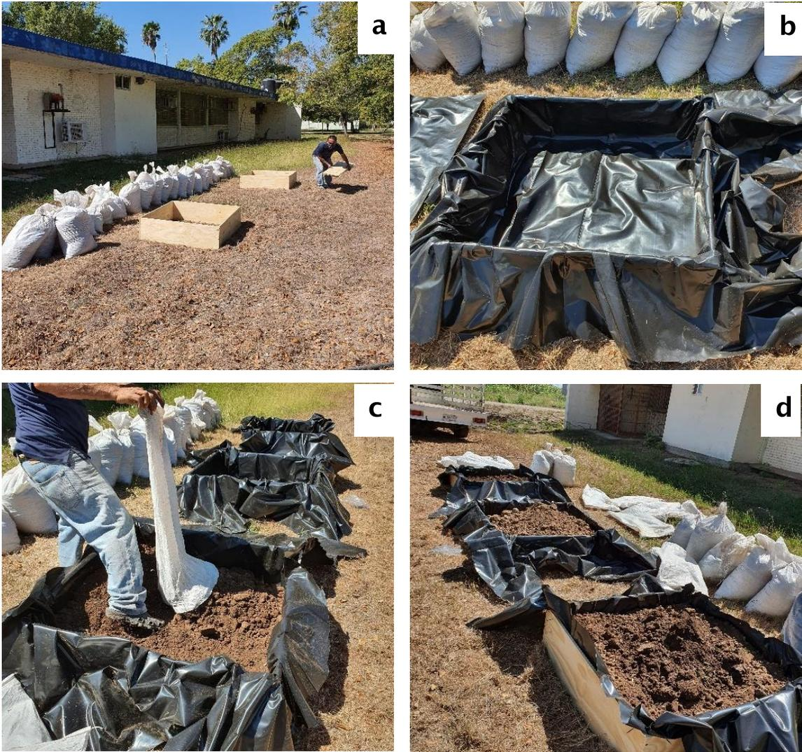
*Nota.* Distribución de costales de muestra (a); Colocación de polietileno negro como membrana en la caja de muestra (b); Distribución del sedimento en cada muestra (c); Vista de las tres muestras (d).
