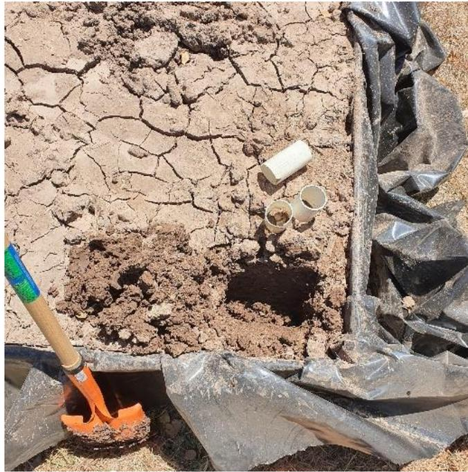
*Nota.* Se aprecia una de las excavaciones con una pala chica para llegar hasta el fondo de la muestra, una vez obtenida la extracción con los tubos desde la superficie, la zona intermedia y el fondo de ésta.
