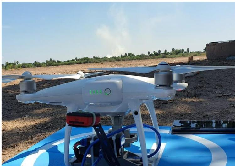
*Nota.* Es la plataforma RPAS utilizada en este proyecto de investigación. En la parte inferior se observa la carga útil, la cual es montada sobre una base impresa en 3D, junto a la batería de LiPo y el Sunshine Sensor.
