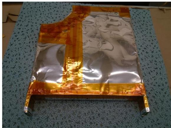
Figura 11. Módulo centellador terminado del sub-detector ADA
