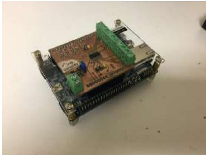
*Figura 3.7 Shield Arduino ADS, conectado a la De0 nano SOC.*
