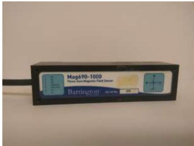
*Figura 3.2 Magnetómetro MAG 690-1000.*
