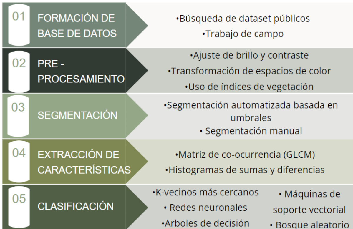
Figura 3.2: Propuesta metodológica de visión por computadora realizada en este trabajo de tesis.
