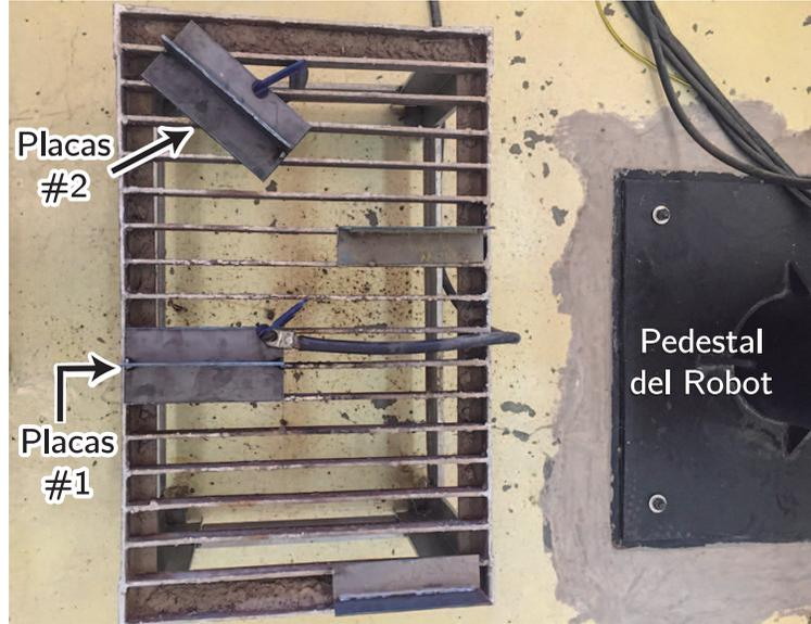
**Figura 6.18.** Placas de soldadura reales en estación de trabajo.
