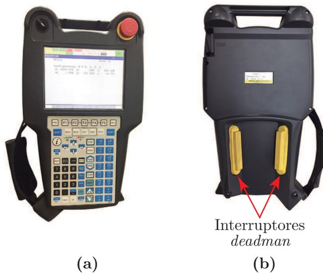
**Figura 6.2.** *Teach-pendant* del robot Fanuc.
