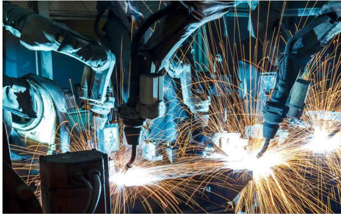
**Figura 2.7.** Soldadura con robots.
