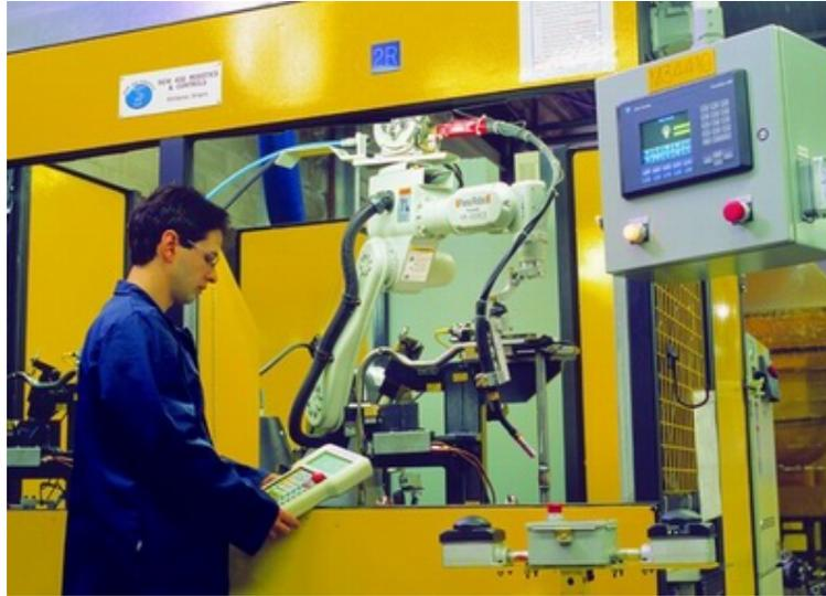
**Figura 2.10.** Operador realiza programación en línea.
