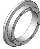
**Figura 4.11.** Modelo del eslabón 6 del robot en SolidWorks<sup>TM</sup>.
