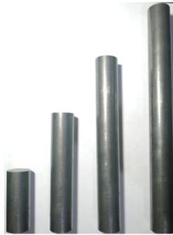
**Figura 3.16:** Barras de acero utilizadas para la calibración de los FSR
